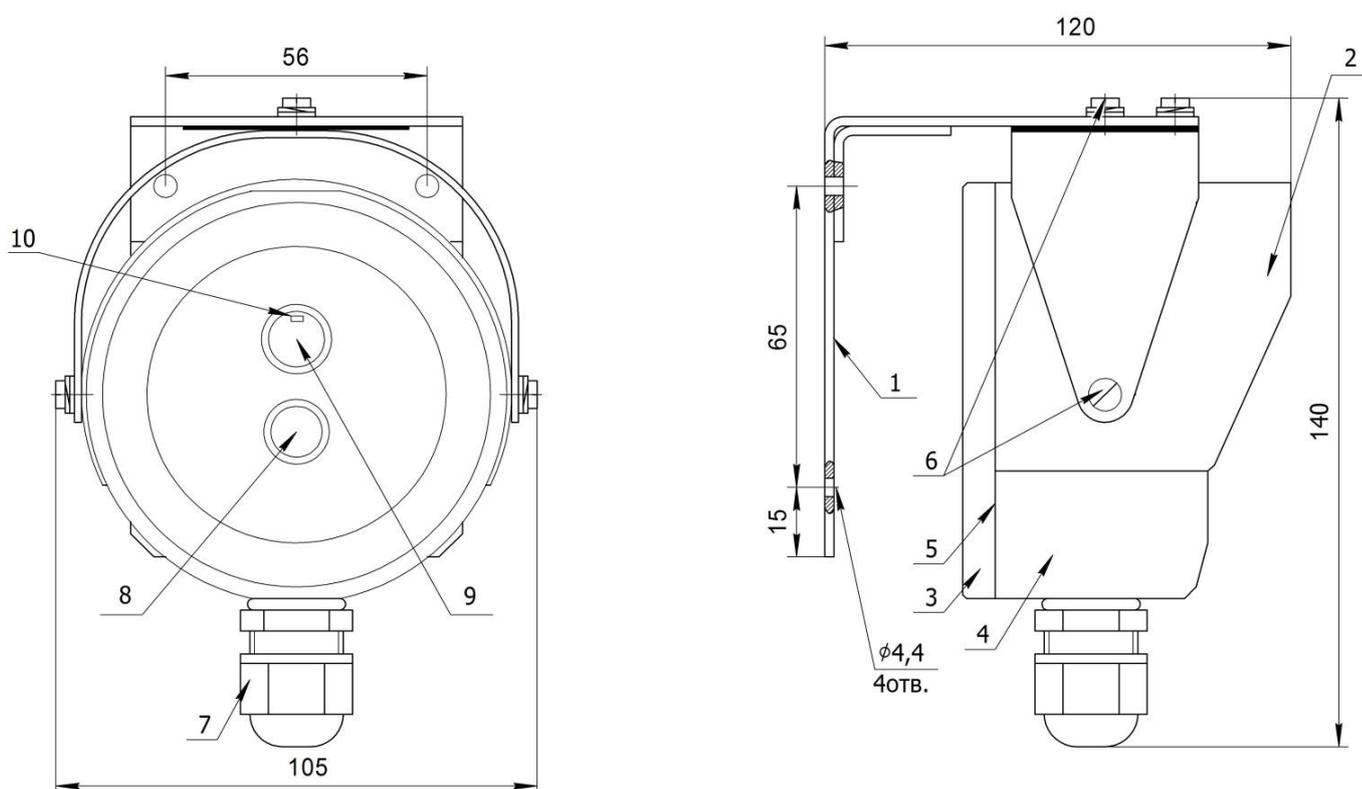
1 – угольник; 2 – козырек; 3 – крышка; 4 – основание; 5 – фланцевое соединение с герметизирующим кольцом; 6 – винтовые соединения; 7 – кабельный ввод; 8 – оптическое окно ИК-канала; 9 – оптическое окно УФ-канала; 10 – светодиодный индикатор.
