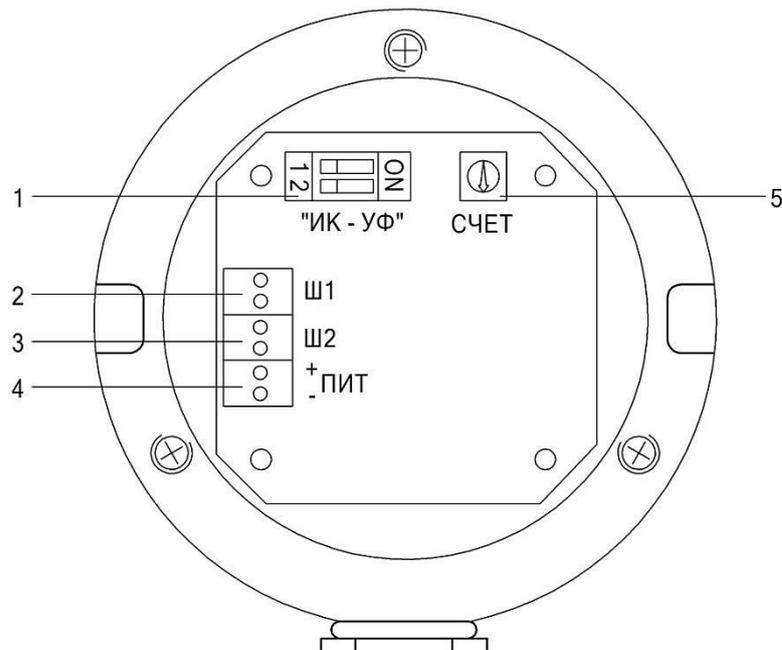
1 – переключатель «ИК-УФ»; 2 – клеммная колодка «Ш1»; 3 – клеммная колодка «Ш2»;
